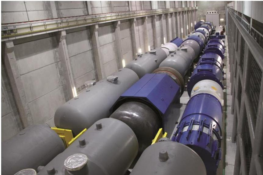
**Abb. 4.1: Abklinglagerung von Großkomponenten im Zwischenlager Nord in Lubmin (Quelle EWN)**
